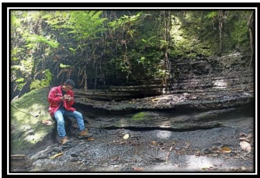
Gambar 14. Perselingan Lempung dan Tuff, (Azimuth Foto N 2800 E), memiliki kedudukan N 250 E/50.
