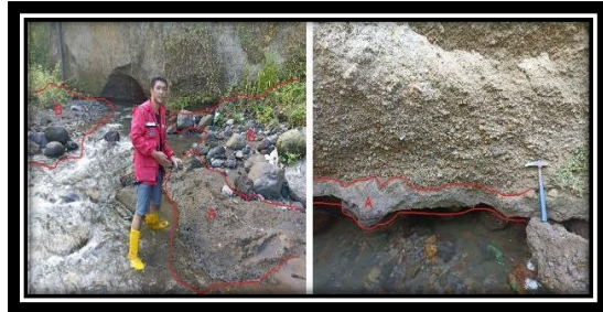
Gambar 3. sisipan tuff pada gambar kanan (A), pada gambar kiri tuff (A), sedimen lepas alluvial (B), LP036 (Azimuth foto N063°E)
